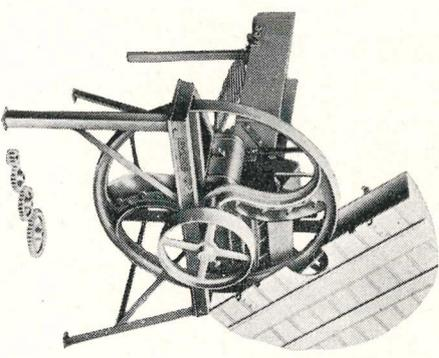
TRINCIAFORAGGIO A MOTORE « FM 31 CS »
