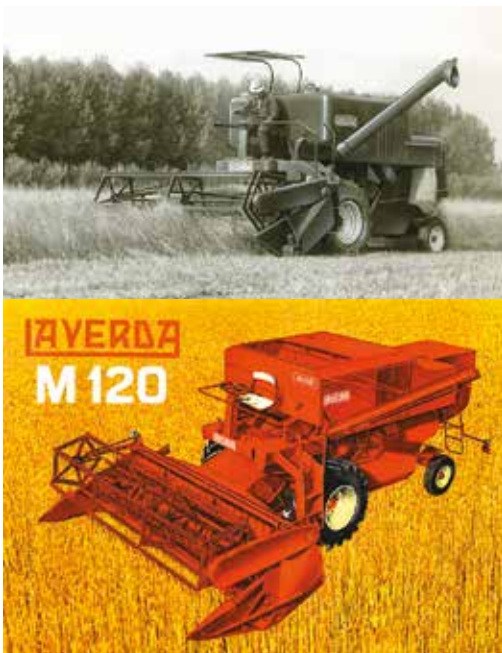
foto 5/6: Il confronto stilistico tra il primo prototipo e la versione definitiva della M 120 evidenzia il fondamentale intervento del designer nel caratterizzare le forme della macchina
