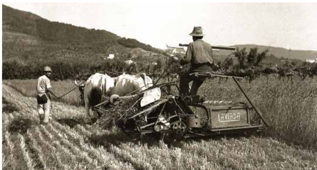
La mietilegatrice, come questa Laverda ML 6, consentiva di tagliare il grano, formare i covoni, legarli e scaricarli a terra in modo automatico. Essa ha rappresentato la massima evoluzione delle macchine da raccolto prima dell'avvento delle moderne mietitrebbie. Bibl. Int. "La Vigna", A.S. Pietro Laverda
